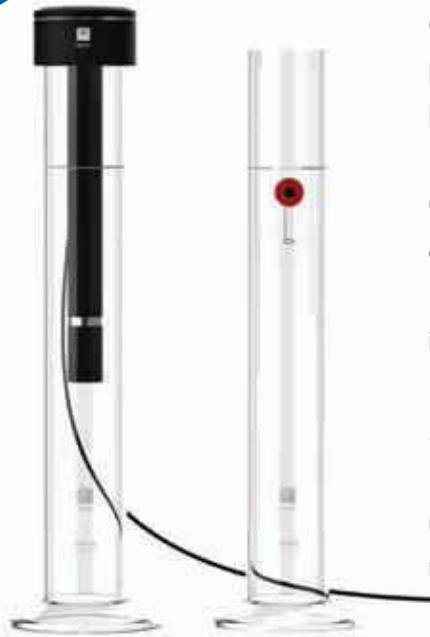
O PARIO reduz erros na determinação do tamanho e distribuição de partículas por eliminar a necessidade de inserir um hidrômetro ou uma pipeta na solução, o que perturba o processo de sedimentação.
